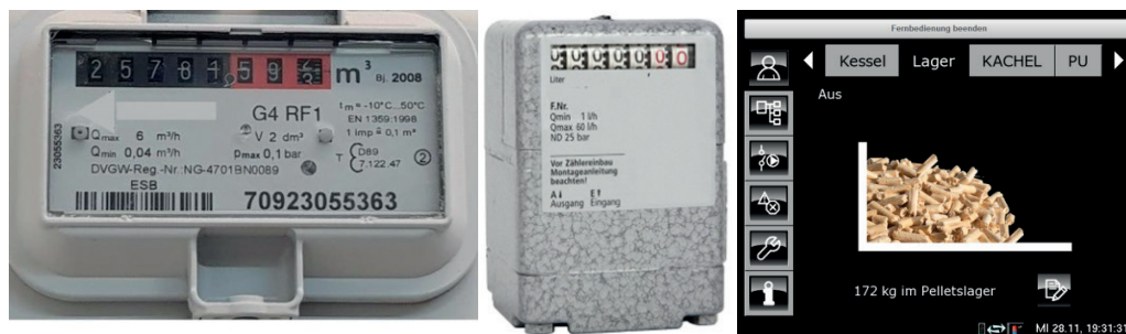
Bild 6: Messung des Brennstoffverbrauchs (links: Gaszähler, Mitte: Öl-Zähler, rechts: Pelletfüllstandsanzeige).
